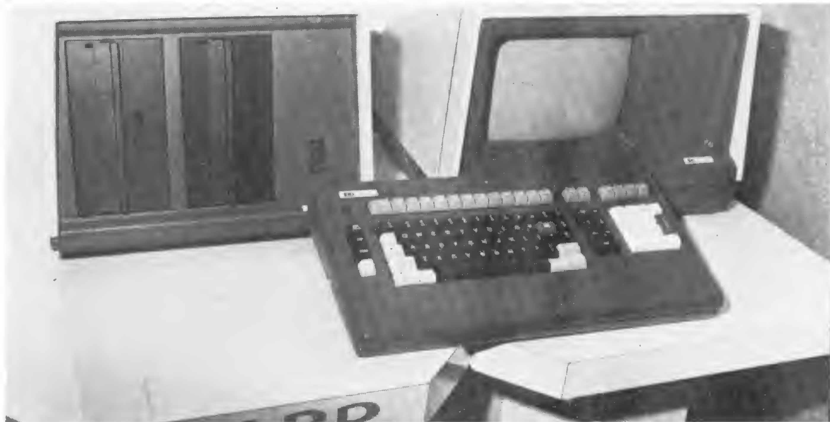
Com 64 K RAM, unidade para dois disquetes de 8" e microprocessador Intel 8085 A, o microcomputador da SID aguarda que sua família cresça: estão programados uma versão maior, o 3900; o irmão mais novo, 3300, com disquete de 5", e um supermicro.
